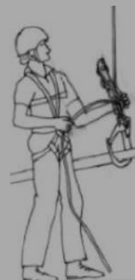
Rys. 5 Instalacja zestawu na dolnym stanowisku
